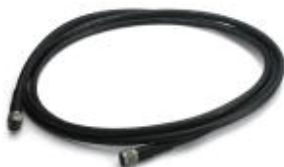
Antennenkabel, 5 m Länge; N (male) -> N (male), Dämpfung ca. 0,45 dB/m bei 2,4 GHz; Impedanz 50 Ohm
