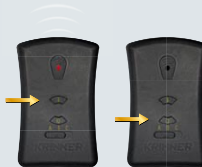
Abb. 6 Ein- oder Ausschalttaste drücken, Signal wird durch rot leuchtende LED angezeigt.
