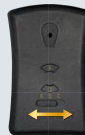
Abb. 6 Ein- oder Ausschalttaste drücken, Signal wird durch rot leuchtende LED angezeigt.
