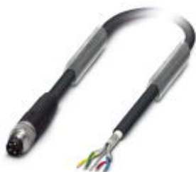
Bussystem-Kabel, INTERBUS, INTERBUS, 4-polig, PUR halogenfrei, schwarz RAL 9005, geschirmt, Stecker gerade M8, auf freies Leitungsende, Kabellänge: 2 m
