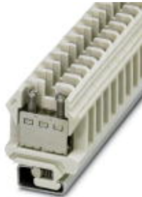
Durchgangsreihenklemme, Anschlussart: Schraubanschluss, Querschnitt: 1 mm 2 - 35 mm 2 , AWG 18 - 2, Farbe: weiß, Montageart: NS 32, Isolationsstoff: Keramik
