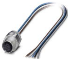
Sensor-/Aktor-Einbaubuchse, 5-polig, M12, A-kodiert, Vorderwand-/Schraubmontage mit Pg9 Gewinde, positionierbar, mit 0,5 m TPE-Litze, 5 x 0,34 mm 2
