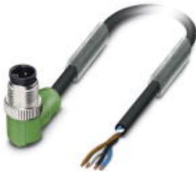
Sensor-/Aktor-Kabel, 4-polig, PUR halogenfrei, schwarzgrau RAL 7021, Stecker gewinkelt M12, A-kodiert, auf freies Leitungsende, Kabellänge: 3 m
