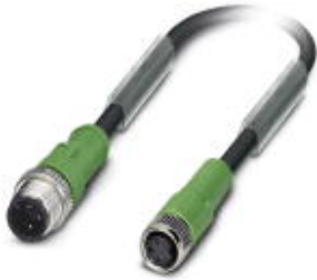
Sensor-/Aktor-Kabel, 3-polig, PUR halogenfrei, schwarzgrau RAL 7021, Stecker gerade M12, A-kodiert, auf Buchse gerade M8, Kabellänge: 0,3 m
