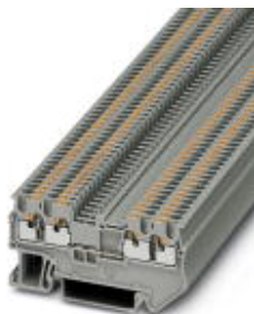
Durchgangsklemme, Anschlussart: Push-in-Anschluss, Querschnitt: 0,14 mm 2 - 1,5 mm 2 , AWG: 26 - 16, Breite: 3,5 mm, Höhe: 30,5 mm, Farbe: grau, Montageart: NS 35/7,5, NS 35/15
