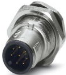
Sensor-/Aktor-Einbaustecker, 8-polig mit Schirmkontakt, M12-SPEEDCON, Hinterwand-/Schraubmontage mit M16 Gewinde, mit geradem Lötanschluss
