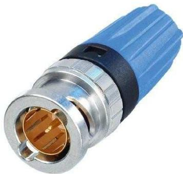
75 Ohm Kabelstecker mit schwarzer Tülle. Passend zu folgenden Kabeltypen: Belden 8241; CAE KX6A; Canare LV-61S; Cordial CVI (CVM) 06-37; CommScope 5563; Draka 0.6/3.7, 0.6 L/3.7; RG59B/U; Sommer 600-0051 (M,L,S), 600-0054 (M,L,S). Bezüglich Kabeltypen, die nicht angeführt sind, kontaktieren Sie bitte unseren Vertreter vor Ort.
