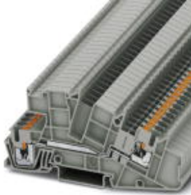
Installationsetagenklemme, Push-in-Anschluss, Querschnitt: 0,14 mm 2 - 4 mm 2 , AWG: 26 - 12, Breite: 5,2 mm, Farbe: grau, Montageart: NS 35/7,5, NS 35/15
