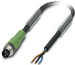
Sensor-/Aktor-Kabel, 3-polig, PUR halogenfrei, schwarzgrau RAL 7021, Stecker gerade M8, auf freies Leitungsende, Kabellänge: 3 m
