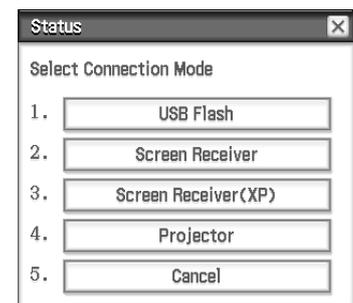
**USB Flash:** Modus zum Anschließen des ClassPad an einen Computer zur Datenübertragung. Siehe „Herstellen und Trennen einer Verbindung mit einem Computer im USB-Flash-Modus“ (Seite 309).
