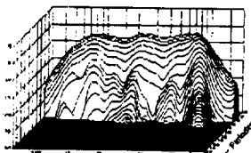
Ausschwingverhalten waterfall spectrum
